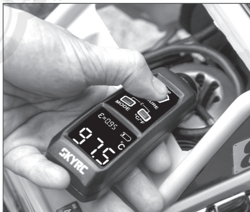
Mesure de température d'un moteur
