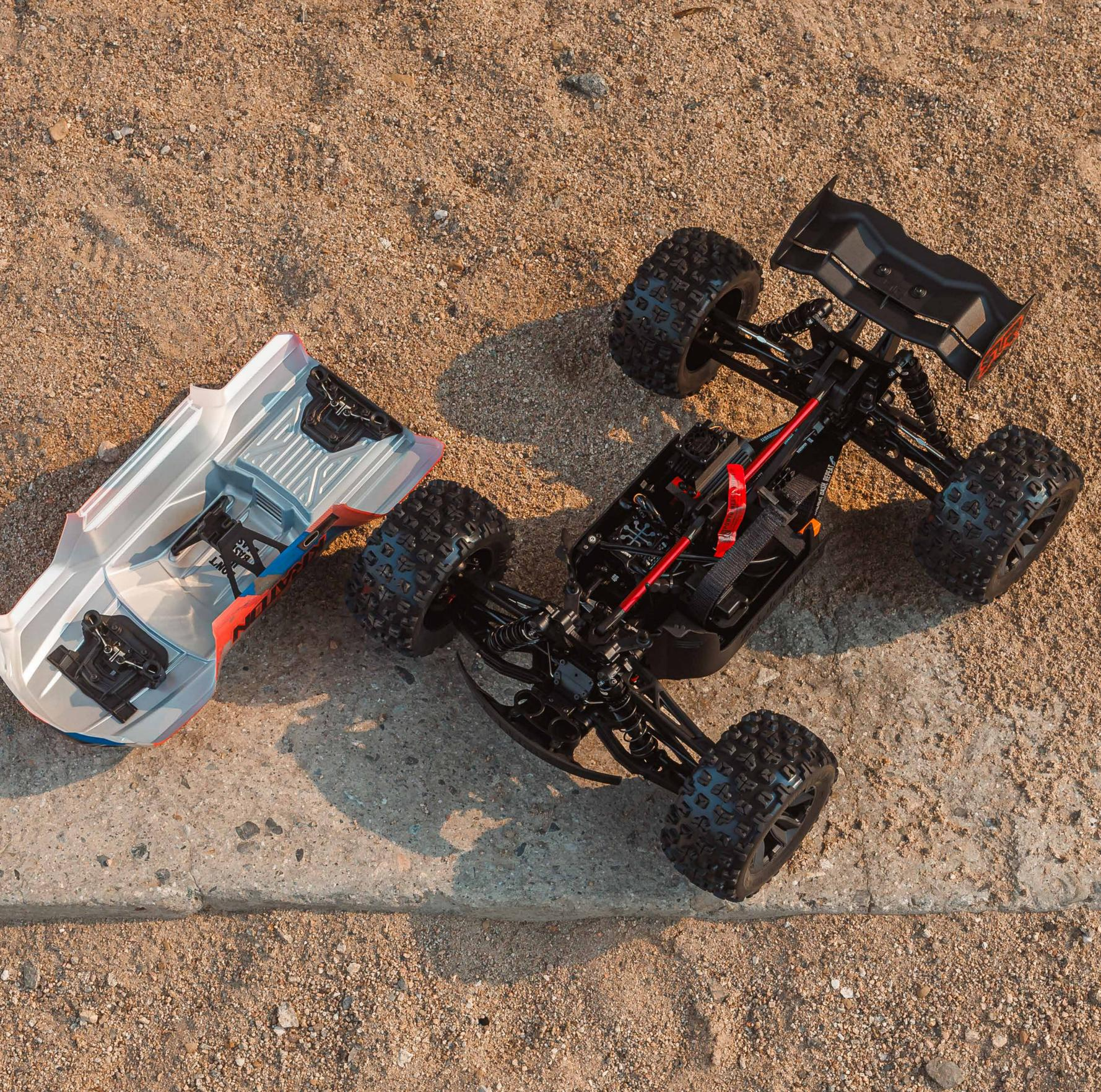
Mit seinem 6S-fähigen brushless Spektrum System erreichst du mit dem KRATON 6S BLX 4X4 unglaubliche Geschwindigkeiten von über 105kmh. Zu den Komponenten gehören ein Firma 150A Smart V2 ESC mit neuer, leistungsstärkerer Firmware, ein Firma 2050Kv brushless Motor und ein zuverlässiges S665 Lenkservo mit Stahlgetriebe. Die Elektronik ist wasserdicht, sodass du unter allen Bedingungen – sogar bei Schlamm oder Schnee – ohne Bedenken losbashen kannst.
